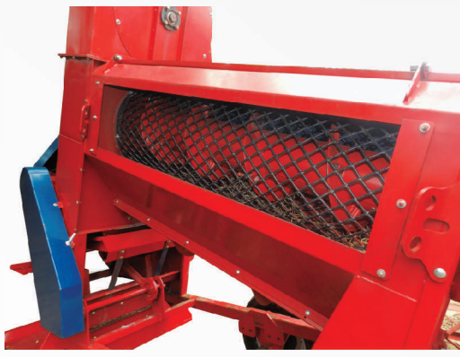
Threshing axial cylinder | Cilindro de trilla y separación
