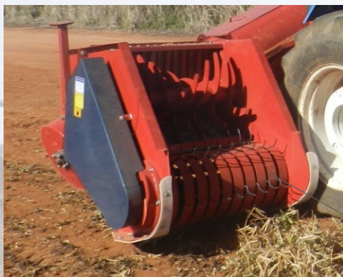
Bean pick up platform with 800mm width Plataforma recogedora de frijol con ancho útil de 800 mm.
